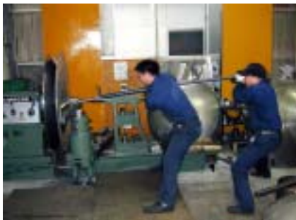
照片 15 大口径半圆拱形状基体的绞加工
